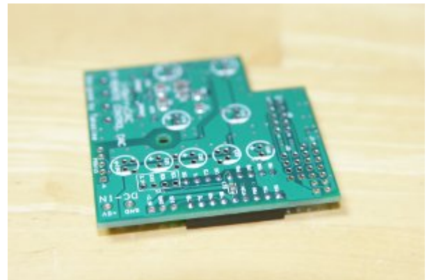
裏返してハンダ付け (部品が浮かないように気をつける)
