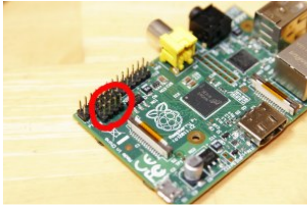
8 ピン ピンヘッダを挿して
